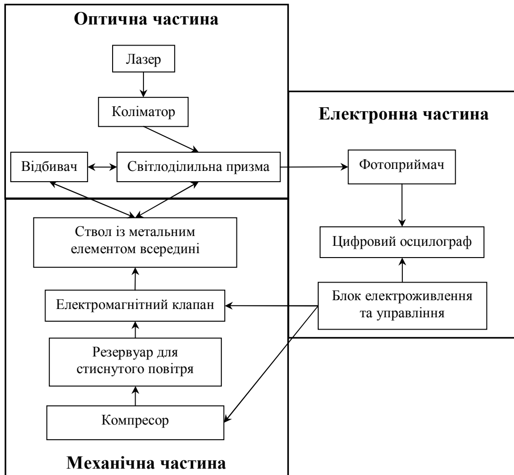
Рис. 4. Структурна схема експериментальної установки
