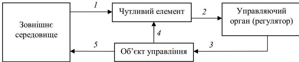
Рис. 1. Типова схема саморегульовальної системи: 1 – вихідна інформація про стан середовища (попередня, поточна і наступна); 2 – оброблена інформація; 3 – управляюча інформація; 4, 5 – зворотні зв'язки
