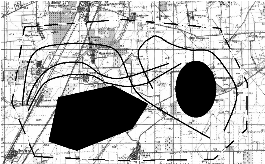
Рис. 8. Можливі траси, побудовані за допомогою траєкторій Д'юбинса (чорним кольором показано дві зони, в яких політ заборонено)
