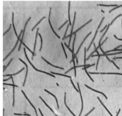
Рис. 2. Защитный экран, в котором использованы отрезки проводящих волокон
