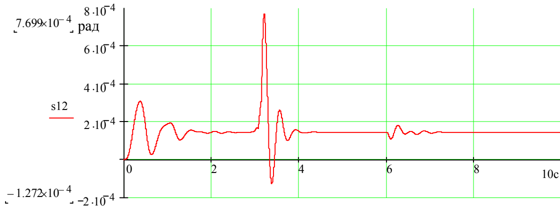
Рис. 6. Осцилограма кутових переміщень \varphi машини ( VA=40 км/год)
