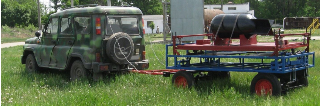
Рис. 3. Фотографія дослідного зразка СТЗ для перевезення небезпечних вантажів під час випробувань
