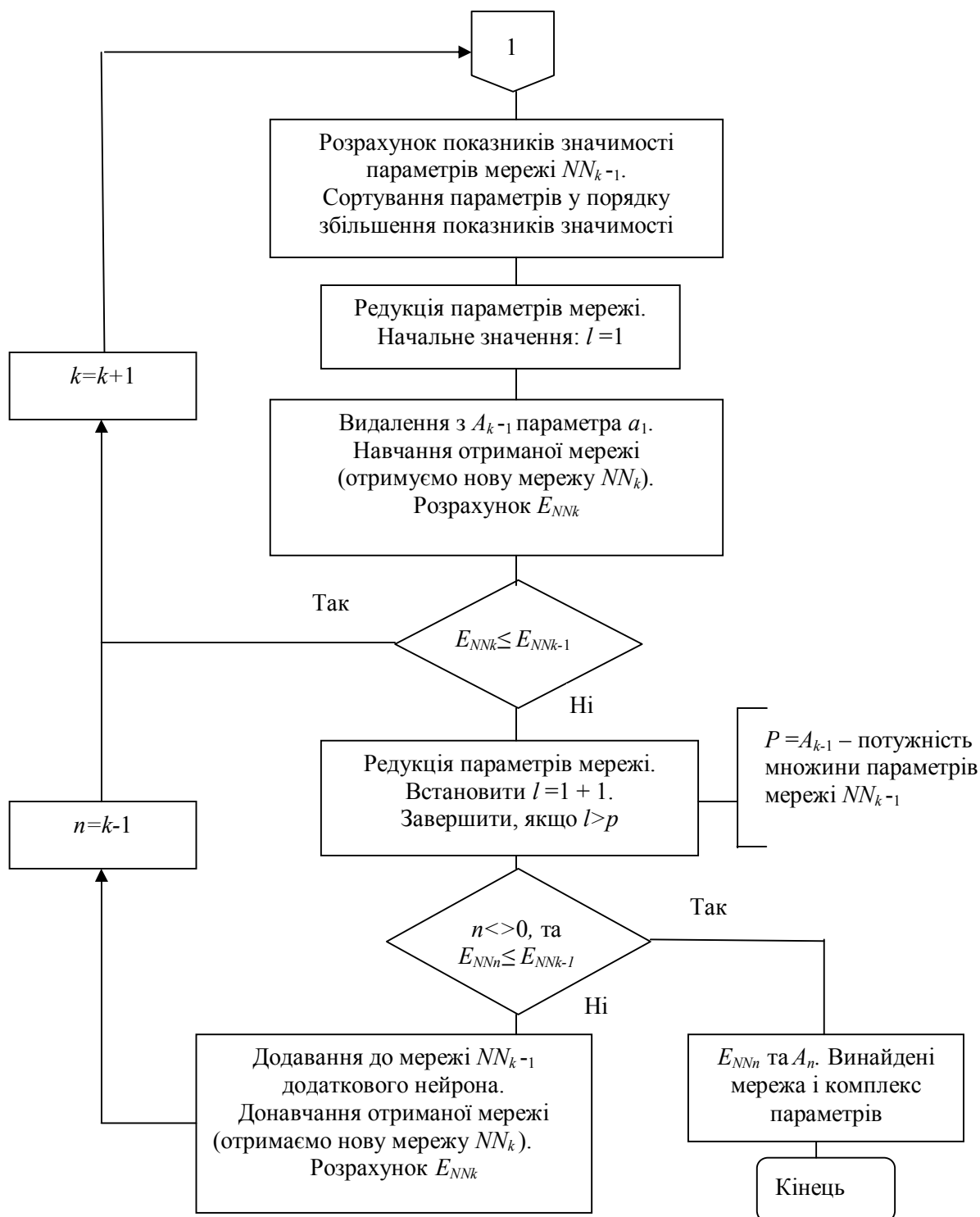
Рис.2. Блок-схема алгоритму методики визначення комплексу прогностичних параметрів і структури нейромережі (закінчення)
