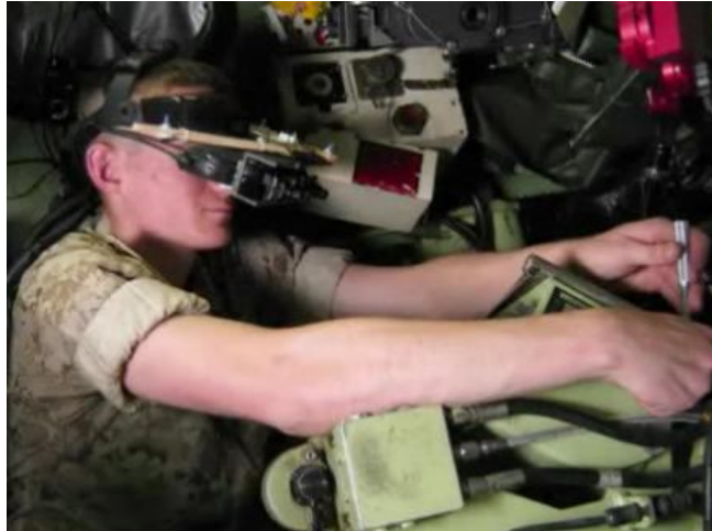
Рис.1. Приклад використання технології доповненої реальності для діагностування та ремонту БМП морської піхоти США
