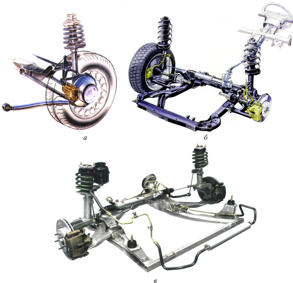
Рис. 1. Стійки підвіски Mac Pherson: а – Alfa Romeo; б – Saab; в – Jaguar X-Туре
