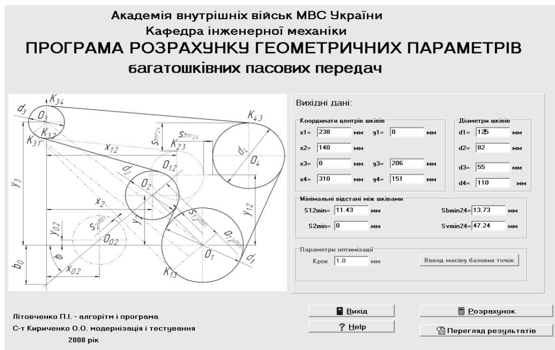
Рис. 4. Головне вікно програми розрахунку геометричних параметрів пасових передач з панеллю вводу даних
