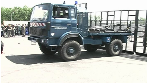
Рис. 2. Мобільна система загороджень на базі автомобільного шасі (Франція)
