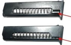
В корпусі магазину більш пізніх років випуску з метою спрощення технології виготовлення замість жолоба для проходження зуба подавача зроблено паз.
