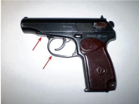
На pistols ранніх років виготовлення передня части рами і спускова скоба мають форму, відмінююся від більш пізніх образців, що обумовлено спрощенням технології виробництва.
