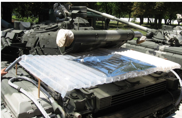
Рис. 2. Розміщення проточного теплового екрана над бронеоб'єктом
