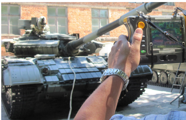
Рис. 3. Оптичне та термографічне зображення частини бронеоб'єкта, що знаходилася у тіні
