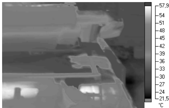
Рис. 4. Термограма лівої частини корми броньованого об'єкта, сформована під дією сонячного випромінювання
