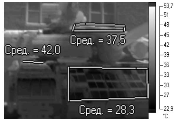
Рис. 3. Оптичне та термографічне зображення частини бронеоб'єкта, що знаходилася у тіні
