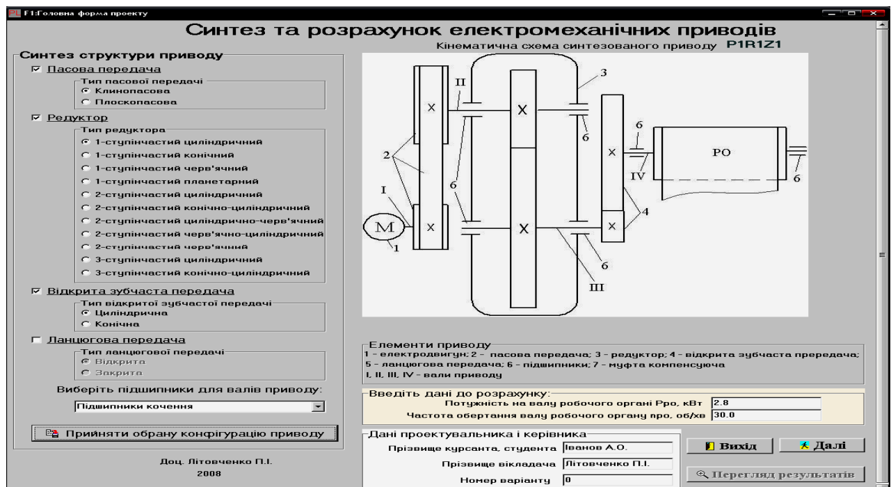
Рис. Програма автоматизованого синтезу та розрахунку параметрів електромеханічних приводів
