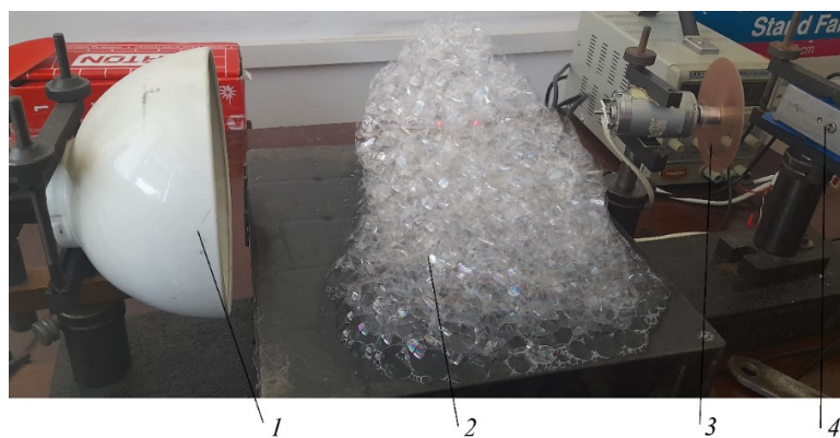
1 – джерело випромінювання; 2 – бульбашкова піна; 3 – модулятор; 4 – триканальний детектор випромінювання
