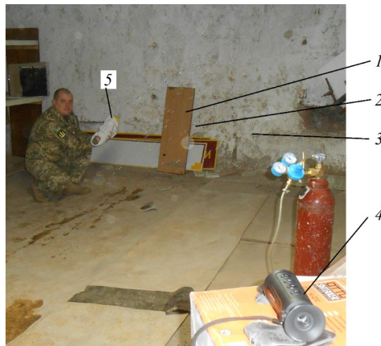
1 – об’єкт спостереження з підвищеною температурою; 2 – бульбашки; 3 – стіна; 4 – тепловізор, 5 – генератор бульбашок
