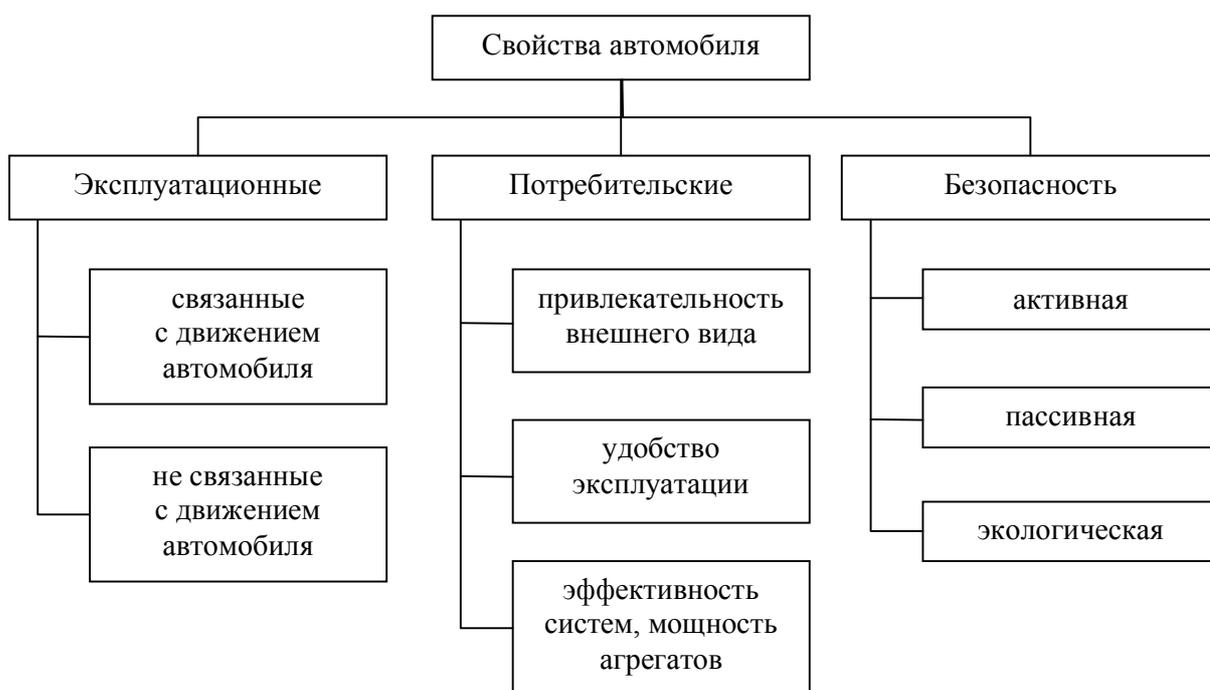
Рис. 1. Классификация основных свойств автомобиля
