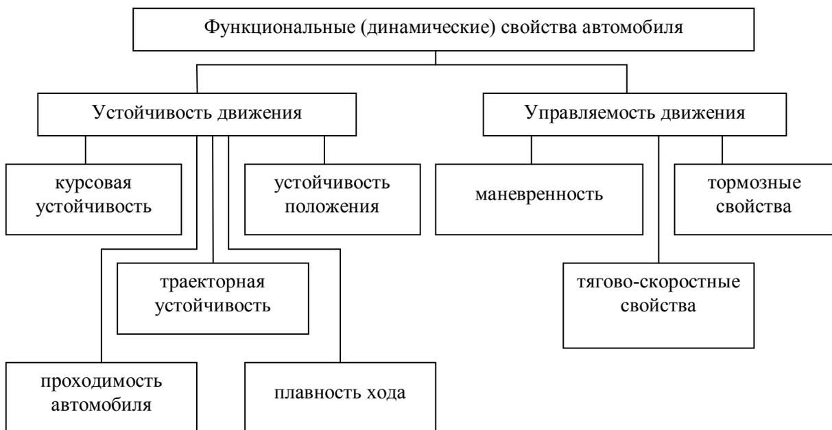
Рис. 3. Функциональные (динамические) свойства автомобиля
