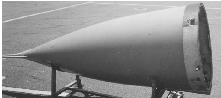
Рисунок 2 – Радіопрозорий конічний обтічник МіГ-29
